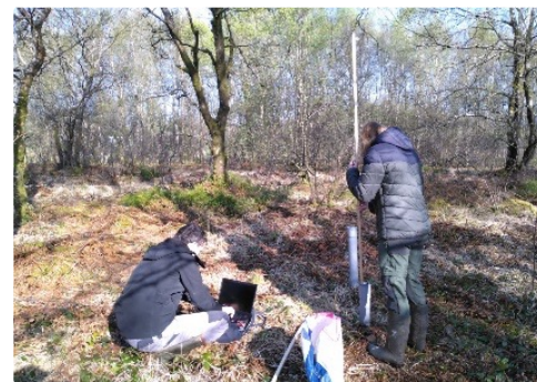
Relevé de sondes piézométriques dans le cadre de l'étude
