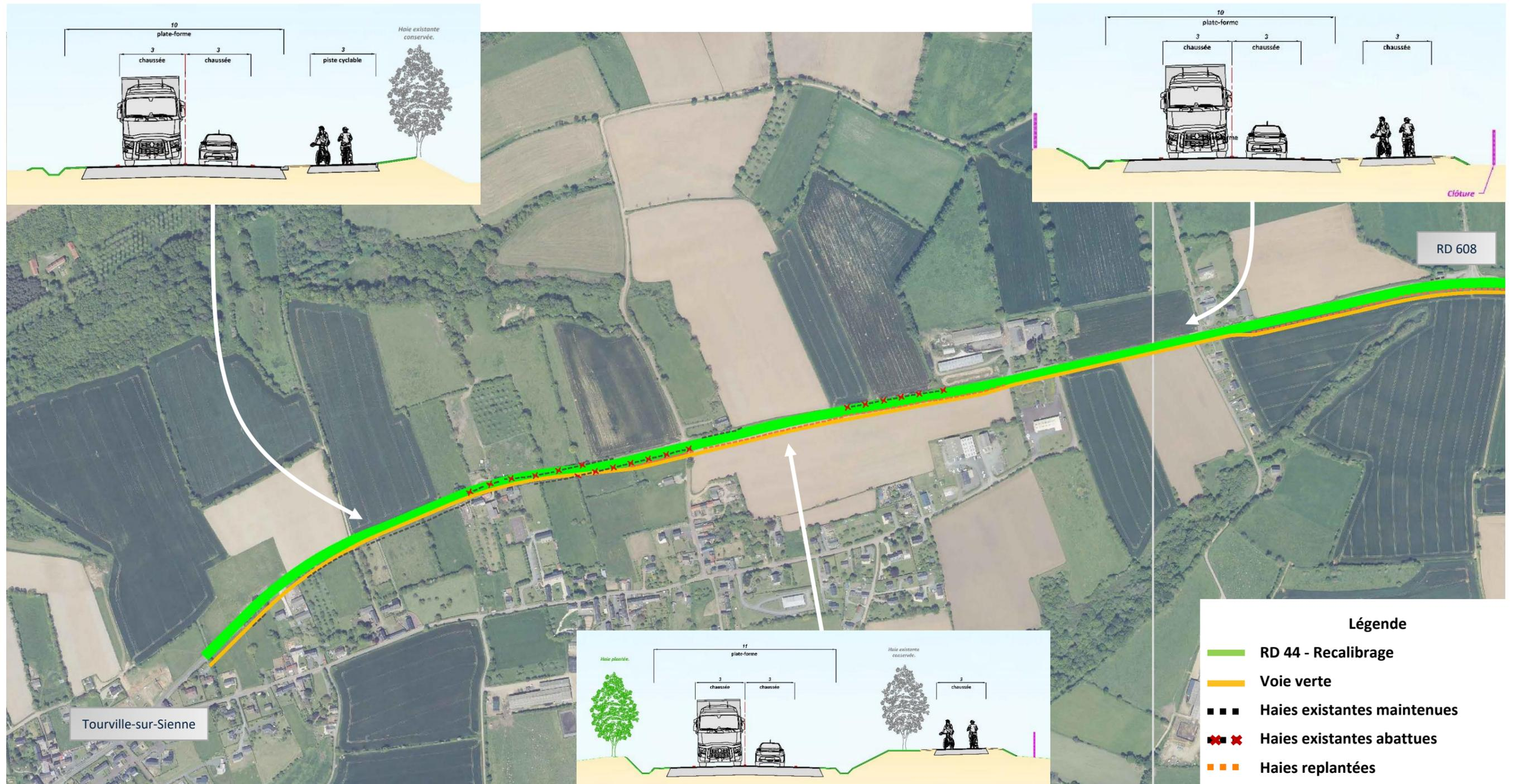
Figure 98 : Plan synoptique du secteur n°5 – Tronçon entrée de Tourville-sur-Sienne-RD 608 et exemples de profils en travers appliqués sur cette section
