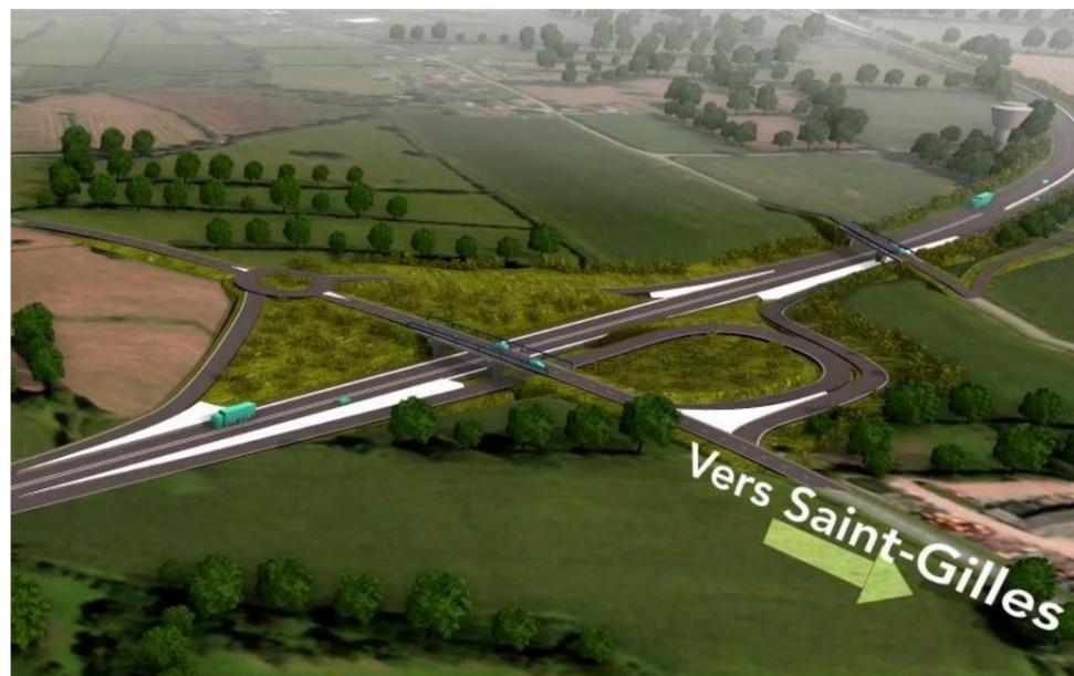
Figure 74 : Vue en 3D de l'aménagement d'un échangeur dénivelé sur la RD 77
