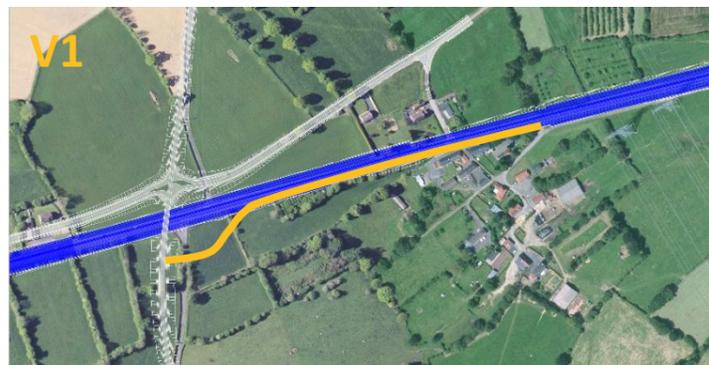
Elargissement de la RD 972 vers le Nord permettant d'utiliser une partie de la chaussée actuelle pour rétablir le hameau vers la RD 972
