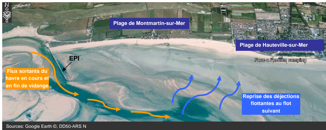
Figure 81 : Schématisation de l'influence de l'épi en sortie du havre de Regnéville
