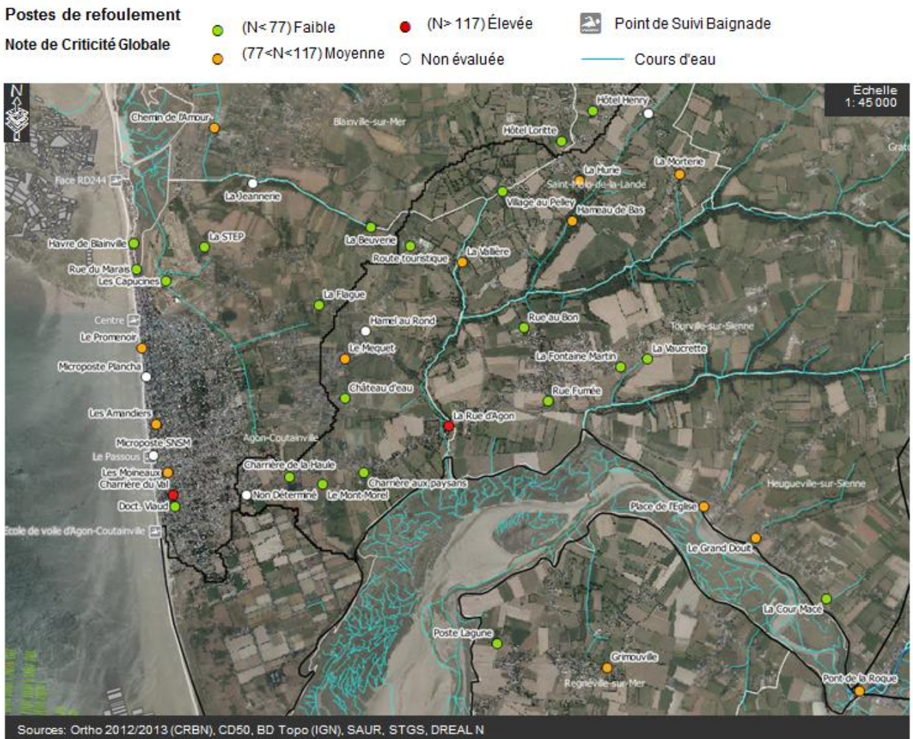
Figure 49 : Criticité globale des postes de refoulement sur le secteur d'Agon-Coutainville / St-Malo-de-la-Lande / Tourville-sur-Sienne / Heugueville-sur-Sienne
