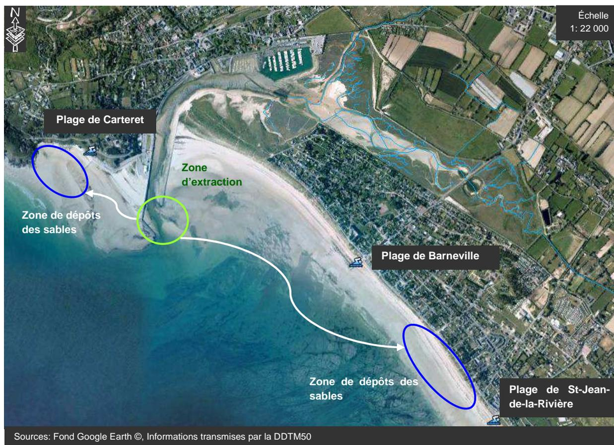
**Figure 28** : Localisation des zones de dépôt des sables dragués (Données DDTM50)
