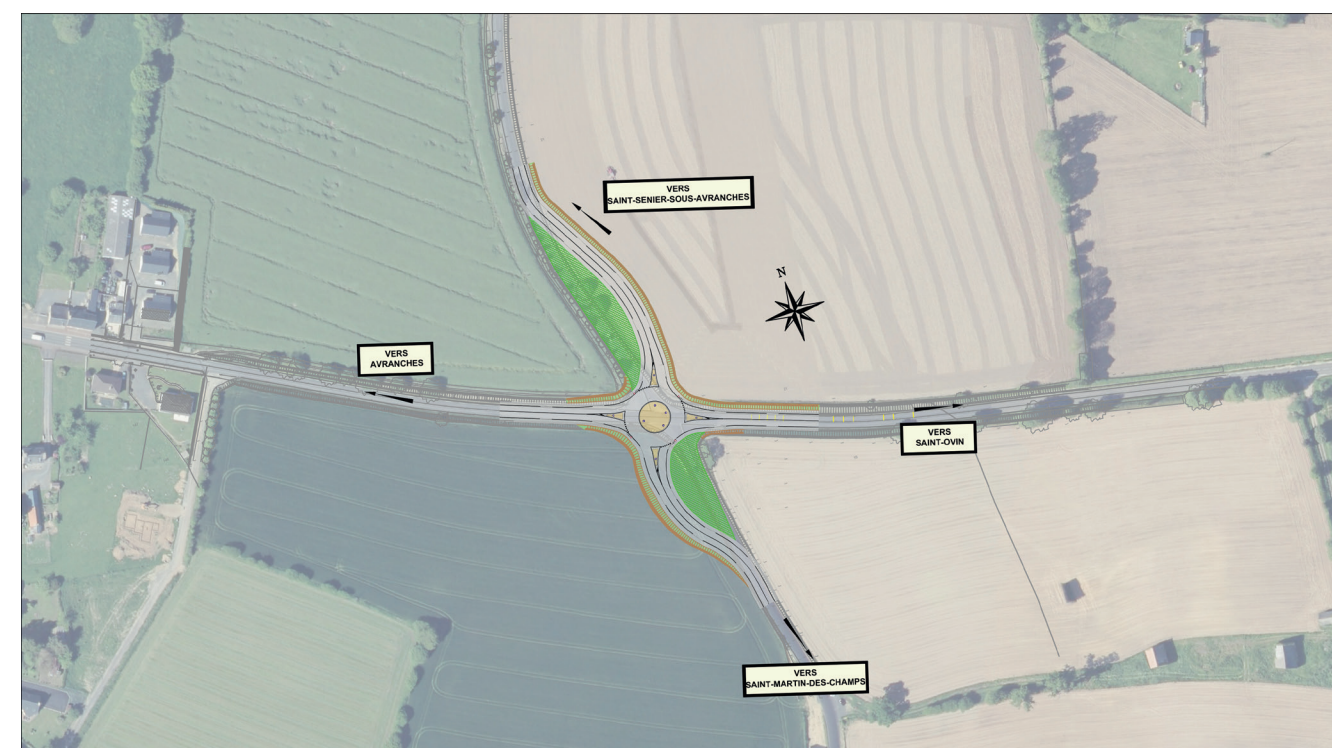
Aménagement d'un giratoire au carrefour de la RD247 et de la RD5
