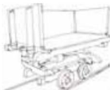
**G** Cet objet, sur roues et rails, servait à transporter du calcaire et du charbon en haut des fours
